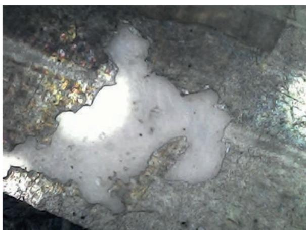
Figura 10 - Imagem microscópica de área de perda da emulsão, indicando ausência de rachas capilares e formação de espelho de prata.
