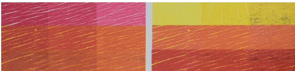
Figura 25 – Autor. (2017). À esquerda faixas com textura de madeira com 100% de Magenta, com faixas de Amarelo sobrepostas. À direita faixas com textura de madeira com 100% de Amarelo com faixas de Magenta sobrepostas. Impressora Epson L 120 formato A4 com 1440 dpi's, s/ papel Canson C A Grain 200g.
