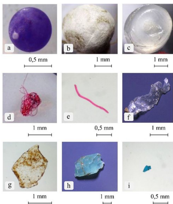
Figura 1: Morfologia dos microplásticos: a) esfera; b) espuma; c) pellet; d) feixe de fibra; e) fibra; f) filme; g, h e i) fragmento.
