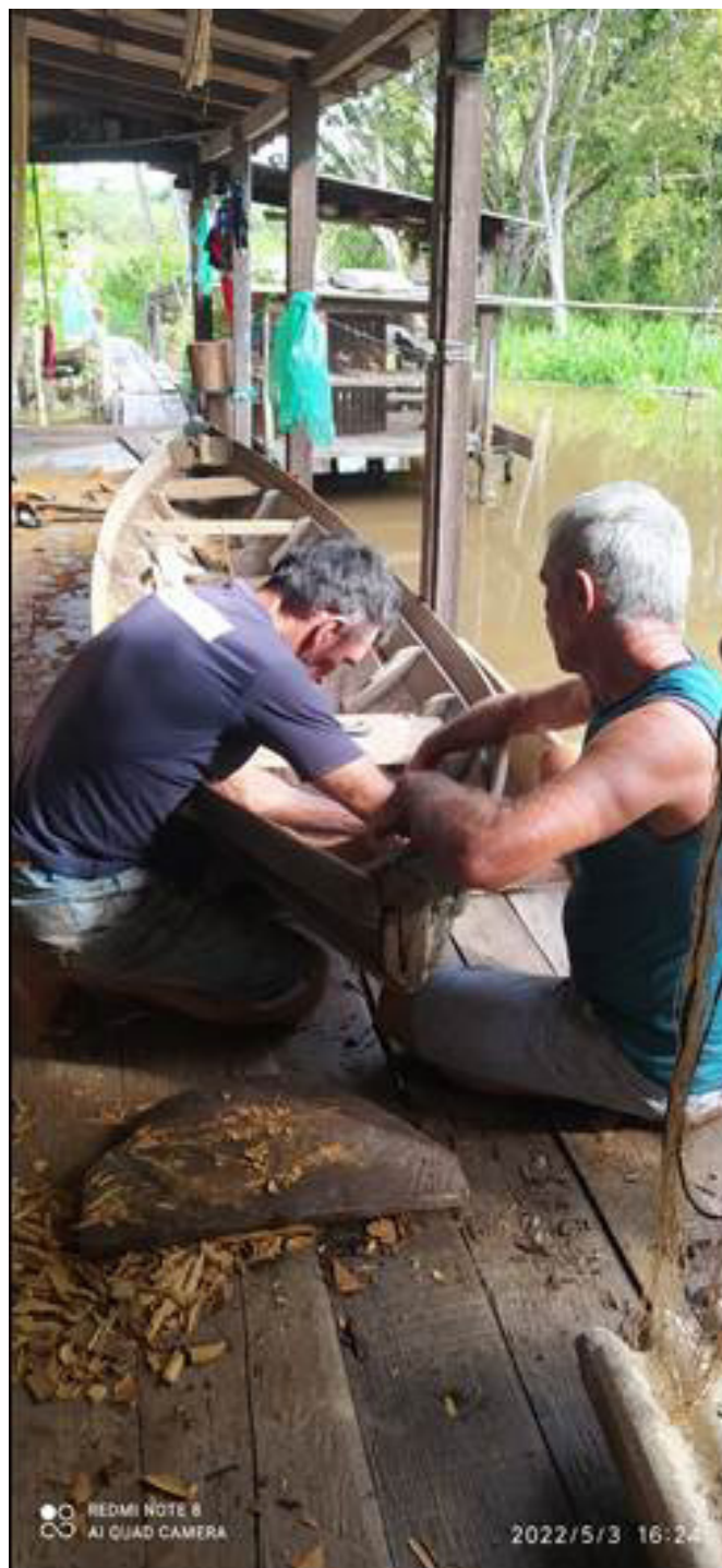
FIGURA 2 - Pescadores consertando a casco da canoa motorizada (bajara) na Comunidade de Água Preta. Projeto Agroextrativista Aritapera, Santarém, Pará, Brasil. Foto: Wandicleia Lopes de Sousa (2022).
